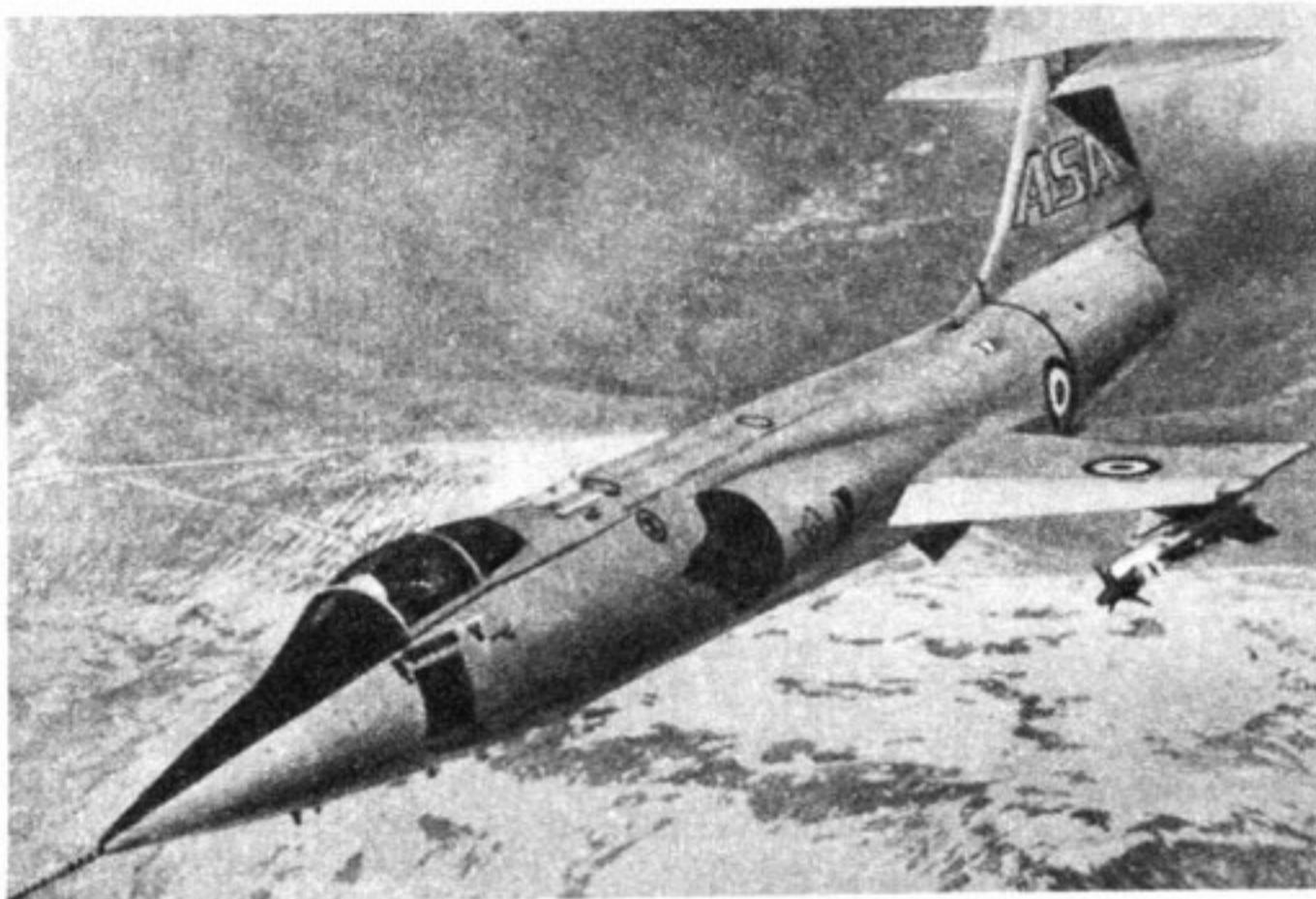
Самолеты F-104S Итальянских BBC будут состоять на службе до 1995 года. Программа усовершенствования ASA (модернизированная система вооружения) предназначена для повышения возможностей перехвата, самообороны, способности нанесения удара с помощью новой радиолокационной станции Фиат R21G/M1 «Сеттер», компьютера управления огнем, усовершенствованной системы радиопротиводействия и другого оборудования. Модернизация коснется, по крайней мере, 140 самолетов.
